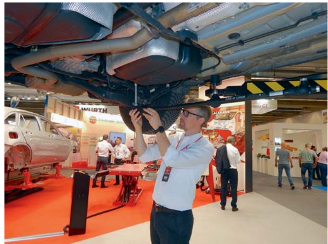
Der handgeführte Messarm PointX-II von Car-O-Liner erlaubt die einfache und schnelle Diagnose-Vermessung.
