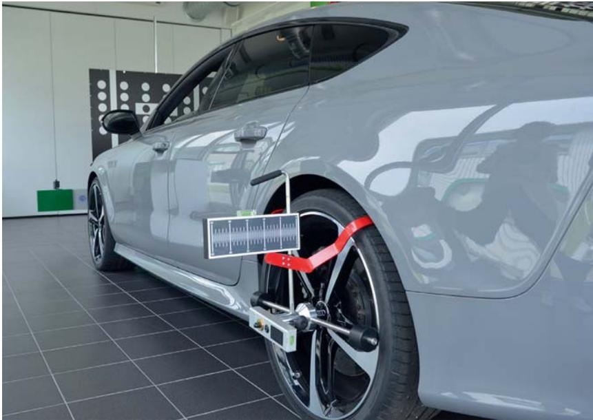
Das CSC Tool ist eine markenübergreifende Lösung zur Kalibrierung von Fahrerassistenzsystemen.
