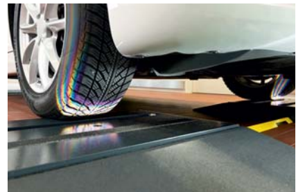
Im Vorbeifahren kann mit Easy Tread die Reifenprofiltiefe gemessen werden.
