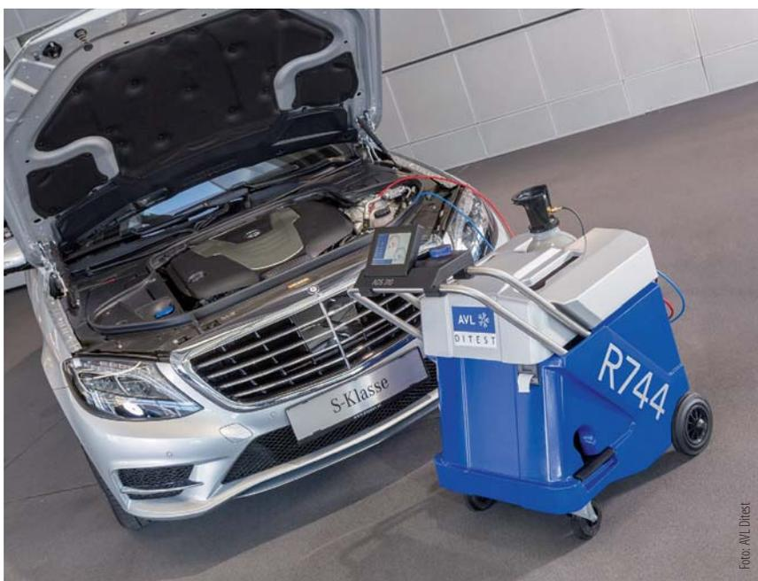
Das CO<sub>2</sub>-Klimatechnikgerät ADS 310 ist bei verschiedenen Fahrzeugherstellern im Einsatz.
