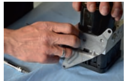
Zunächst muss der Halter des ABS-Steuergeräts entfernt werden.
