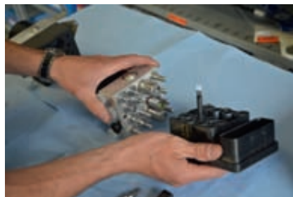
Die neue Hydraulikeinheit wird vorsichtig an der alten Elektronikeinheit befestigt.
