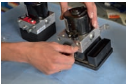
Durch Lösen der zwei Schrauben lässt sich die Hydraulikeinheit abnehmen.
