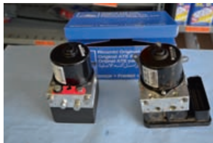
Die neue Hydraulikeinheit (links), daneben die alte HCU mit Elektronikeinheit.
