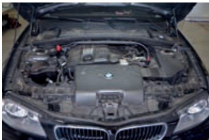
Unter der Wasserkastenabdeckung oben rechts befindet sich das ABS-Steuergerät.
