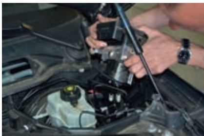
Das komplette ABS-Steuergerät wird aus dem Motorraum entfernt.
