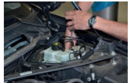
Die Bremsflüssigkeitsleitungen und Haltemuttern des Halters müssen gelöst werden.
