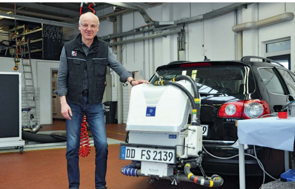
Jürgen Bönninger, Geschäftsführer der FSD Fahrzeugsystemdaten GmbH in Dresden mit einem Messgerät zur Abgasmessung im normalen Straßenverkehr
