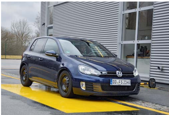
Während der HU sollen Autos künftig auf einer nassen Testfläche bremsen. Dank dem HU-Adapter ist feststellbar, ob das ABS regelt. Das Verfahren soll Bremsprüfstände langfristig überflüssig machen.
