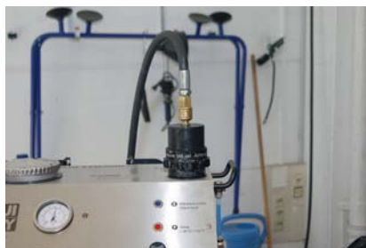
Der Druckluftadapter fördert die Ansaugreiniger-Flüssigkeit in den Ansaugtrakt.
