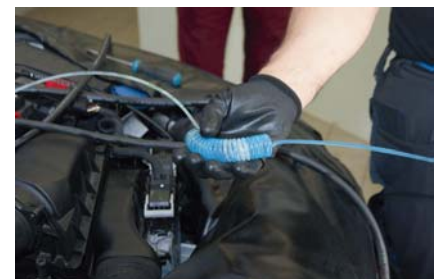
Die Fördermenge kann über eine Schlauchwendel kontrolliert werden.
