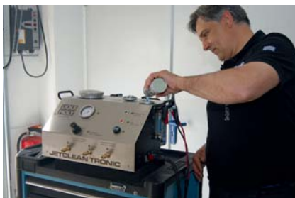
Reiner Schönfelder befüllt den Ansaugreiniger-Tank mit spezieller Reinigungsflüssigkeit.
