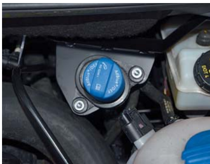
Der AdBlue-Tankstutzen sollte leicht erreichbar sein: Beim T5 befindet er sich direkt im Motorraum.
