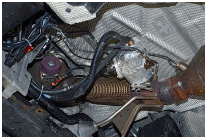
Bauraum kein Problem: Die Harnstoff-Lösung gelangt mit Hilfe des Hydrolyse-Reaktors (Mitte) nach dem Partikelfilter in den Abgasstrom.
