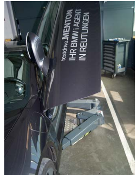
Mit Stempelbühnen lassen sich moderne Flügeltüren beim angehobenen Fahrzeug öffnen.
