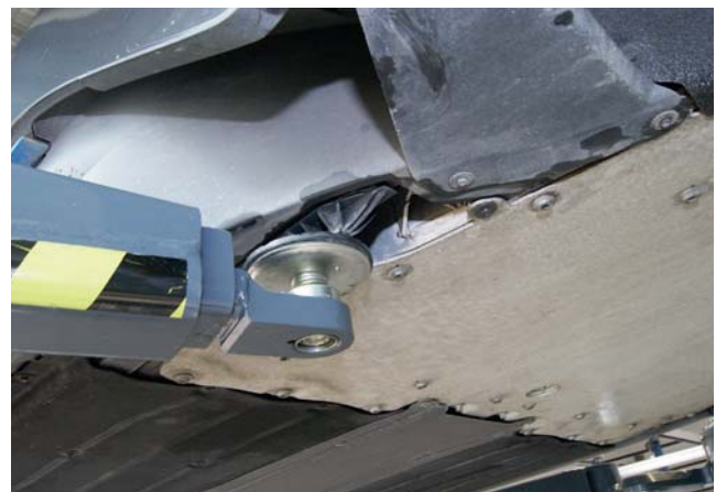
Die Tragarme sollten sich mit unterschiedlich hohen Steckpilzen ausrüsten lassen, um ein sicheres Anheben zu gewährleisten.
