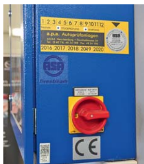
Damit mit dem Bremsprüfstand die HU durchgeführt werden darf, ist eine DAKS-Kalibrierung nötig. Der kleine schwarz-weiße Aufkleber auf dem Kontrollkasten (l.) belegt diese. Im Kasten befindet sich die Asanetwork-Livestream-Schnittstelle. Mit ihr lassen sich in Echtzeit Daten auslesen. Die Messwerte liefert der orange leuchtende Abnehmer an den Rollen des Bremsprüfstands (r.).
