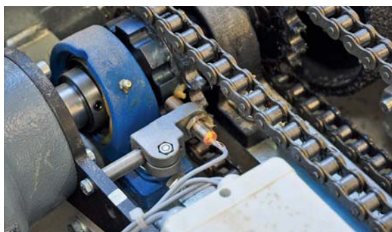
Damit mit dem Bremsprüfstand die HU durchgeführt werden darf, ist eine DAKS-Kalibrierung nötig. Der kleine schwarz-weiße Aufkleber auf dem Kontrollkasten (l.) belegt diese. Im Kasten befindet sich die Asanetwork-Livestream-Schnittstelle. Mit ihr lassen sich in Echtzeit Daten auslesen. Die Messwerte liefert der orange leuchtende Abnehmer an den Rollen des Bremsprüfstands (r.).
