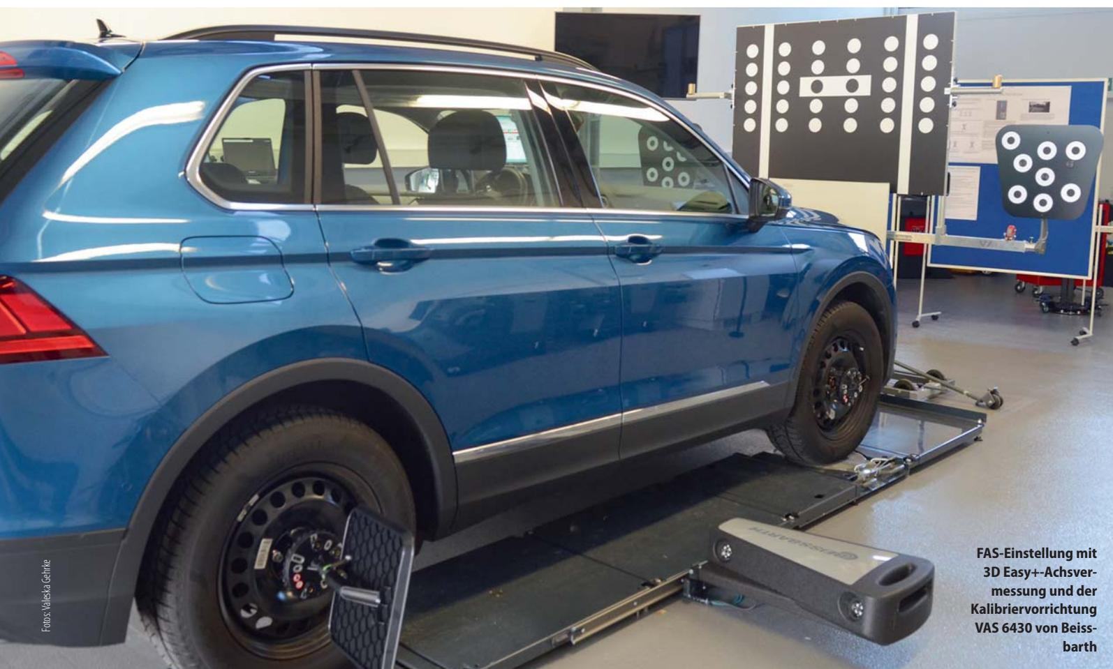
FAS-Einstellung mit 3D Easy+-Achsvermessung und der Kalibriervorrichtung VAS 6430 von Beissbarth
