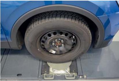
Das Fahrzeug positionieren. Drehteller und Schiebepplatten brauchen immer freies Spiel.
