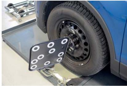
Die Messwerttafeln an den Rädern befestigen und anhand der Wasserwaagen ausrichten.
