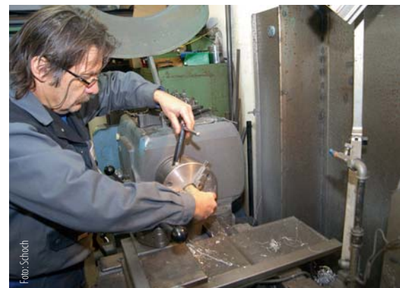
Peter Steger zeigt an einer Drehbank, wie wichtig eine schattenlose Ausleuchtung dieses unfallträchtigen Arbeitsbereiches ist.
