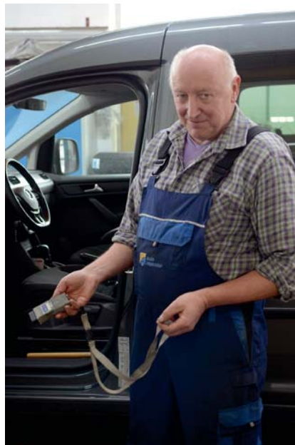
Jürgen Scherner schließt das VCI an. Es leuchtet grün, sobald es Verbindung zum PC hat.
