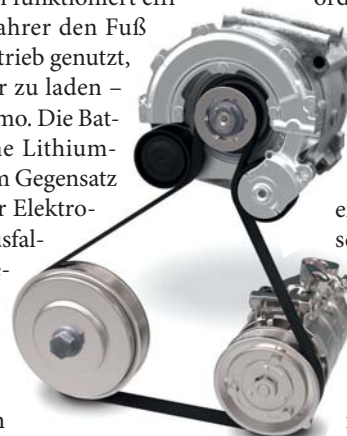
In einer P0-Anordnung ist ein Mild-Hybrid leicht realisierbar.
