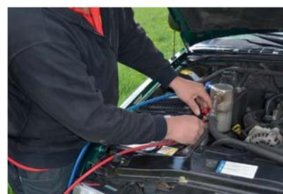
**... und anschließend mit der Nieder- und Hochdruckleitung der Klimaanlage verbunden.**
