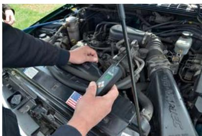
**Das Lecksuchgerät kann anschließend den aus tretenden Wasserstoff lokalisieren.**
