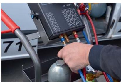
**Blauer und roter Schlauch werden nun am Dichtheitsprüfgerät angeschlossen ...**
