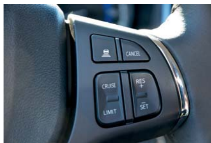
Highlight des Baleno ist der adaptive Tempomat, der einen Radarsensor nutzt.
