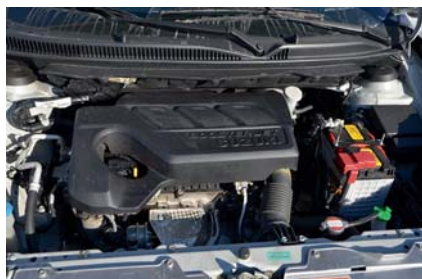
Platzsparend: Der Dreizylinder-Turbobenziner quetscht 111 PS aus einem Liter Hubraum.
