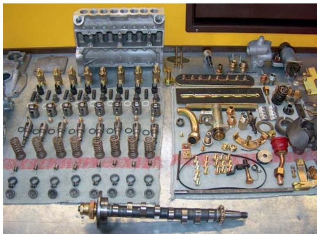
Lassen sich Ersatzteile nicht mehr beschaffen, ist oft die Reparatur der alten Teile der letzte Ausweg.
