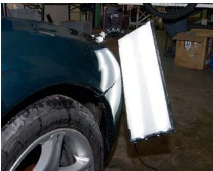
Der Parkrempler im vorderen rechten Kotflügel zeigt sich deutlich im Lichtschein der Karosserielampe.
