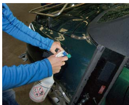
Wenn der Haken nicht mehr gebraucht wird, kann er leicht mit Hilfe eines Reinigers von der Karosserie gelöst werden.
