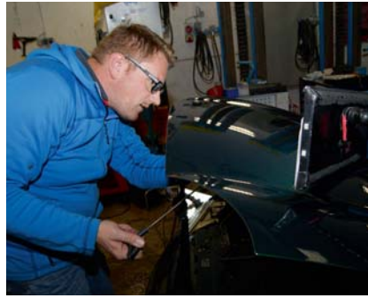
Mit speziellen Haken drückt Steve Baumgarten die Dellen aus der Kofferraumhaube des beschädigten MG F.
