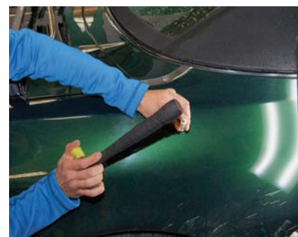
Auch beim Ziehen einer Delle entsteht eine Beule. Sie wird mit dem Teflon-Schlagdorn egalisiert.
