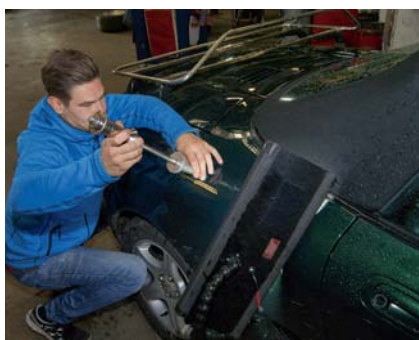
Mit Hilfe eines Zughammers wird anschließend die Delle vorsichtig aus der Karosserie gezogen – dabei muss auf den Lack geachtet werden.
