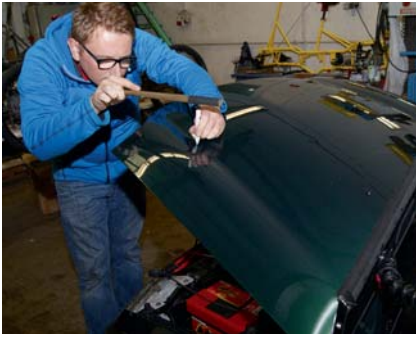
Viel Erfahrung ist notwendig, um Dellen oder Beulen aus einer Karosserie beschädigungsfrei zu entfernen.
