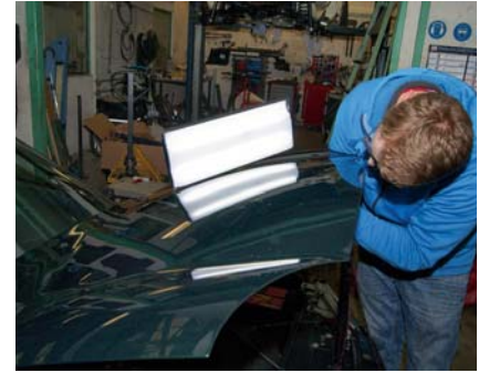
Im Lichtschein der Karosserielampe sieht Steve Baumgarten, wie viel Druck notwendig ist, um die Delle herauszumassieren.
