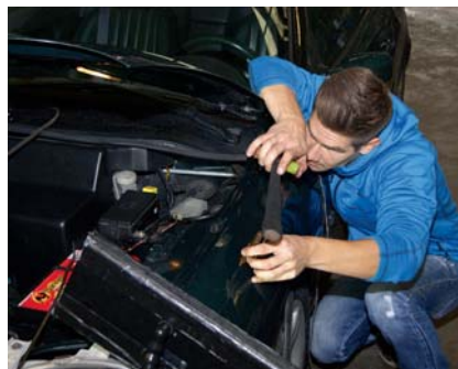
Nach dem Herausdrücken der Delle muss die entstandene Beule mit einem Teflon-Schlaghorn egalisiert werden.
