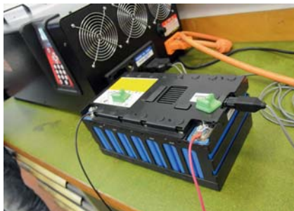
Ein einzelner Zellblock besteht aus bis zu zehn Zellen, die bis 365 Volt Spannung liefern.
