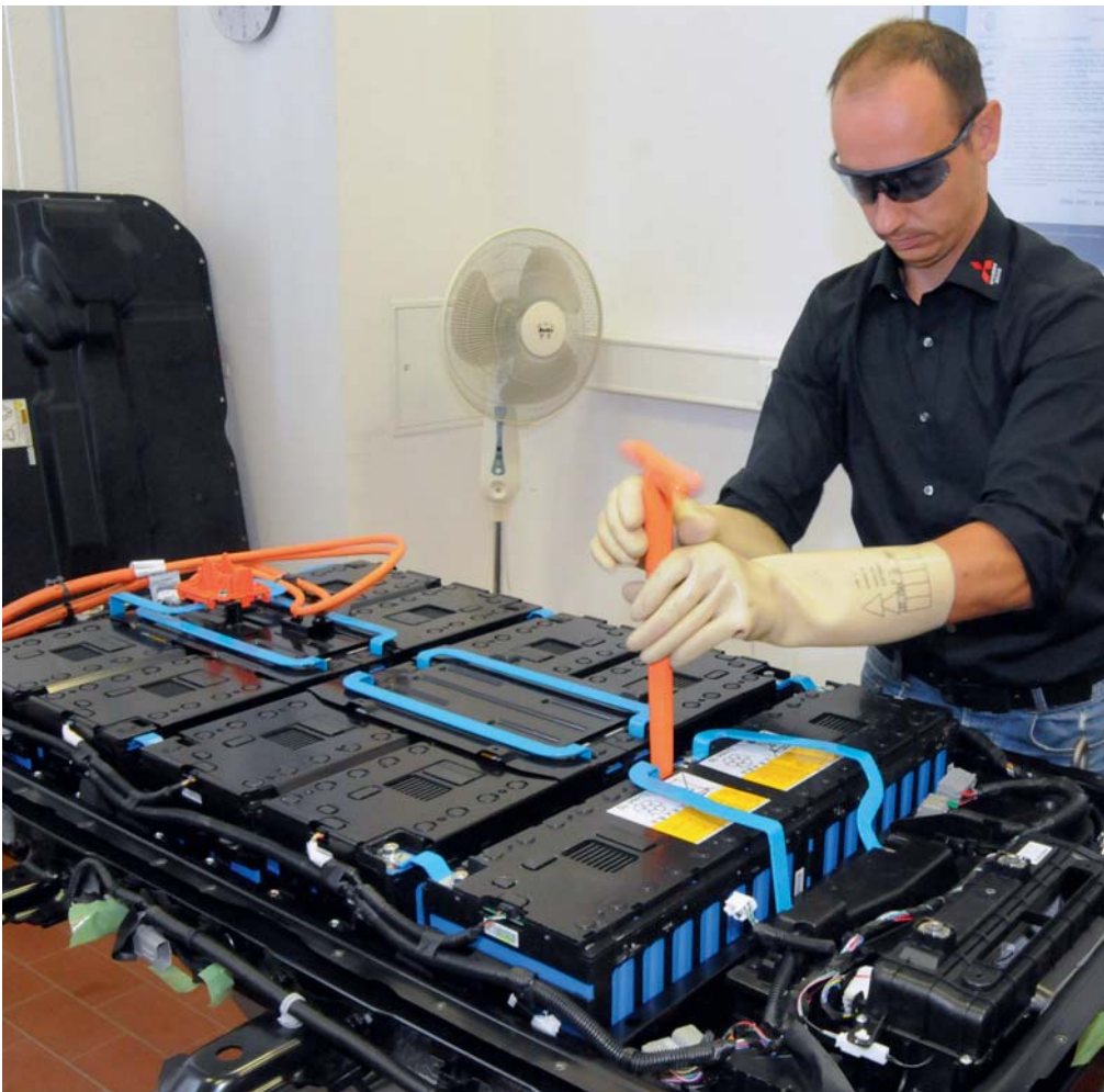
Austauschbar: Traktionsbatterien in E-Autos bestehen aus einzelnen Zellblöcken.
