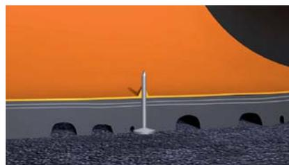
Mit „ContiSeal“ wird ein Durchstich im Reifen bis fünf Millimeter Durchmesser versiegelt.
