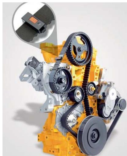
Das Frequenzmessgerät „Belt Tension Tester Mini“ hilft bei Einstellung des Riemtriebs.
