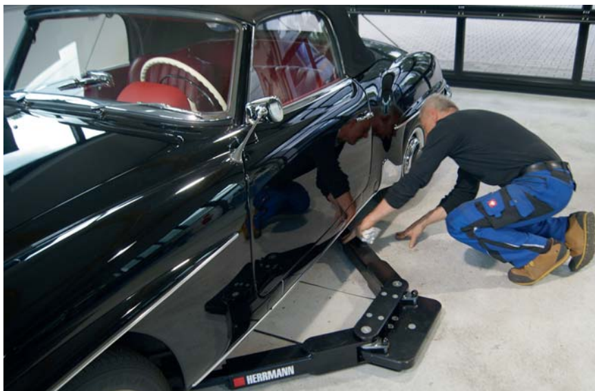
Dank einer Einschwenkhöhe von 96 Millimeter können die Tragarme auch unter tief liegende Sportwagen greifen.
