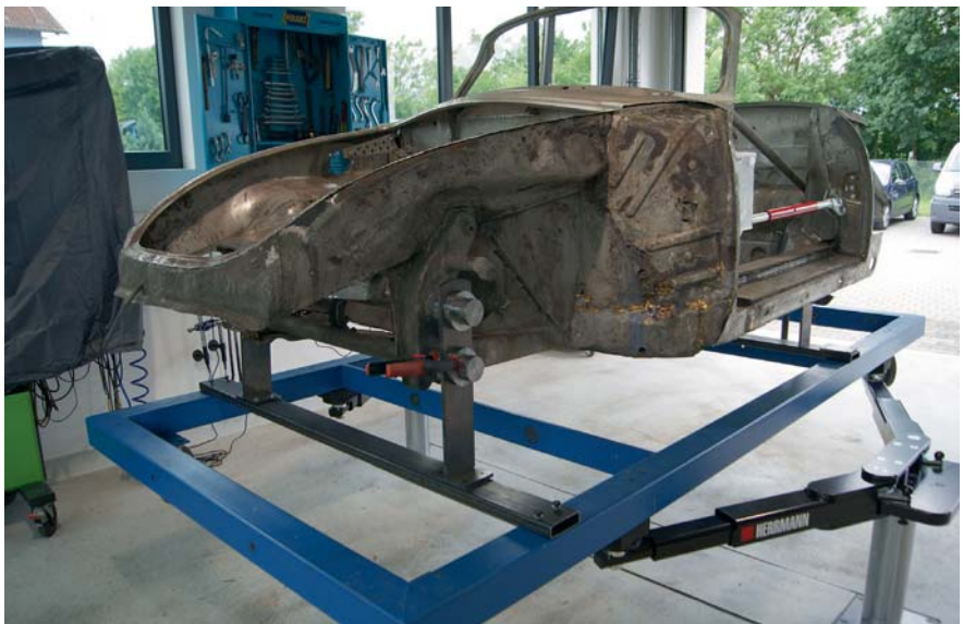
Stark korrodierte Fahrzeuge wie dieser Porsche 356 B Cabriolet (Bj. 1961) benötigen einen Hilfsrahmen zum Anheben.
