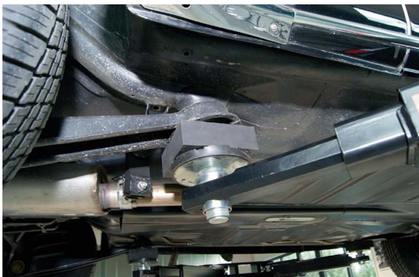
Beim Ansetzen ist auf genügend Luft zwischen Tragarmen und Karosserieteilen zu achten.
