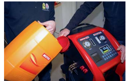
Nach der Spülung und Reinigung wird frisches Automatikgetriebeöl in das Getriebe gepumpt.
