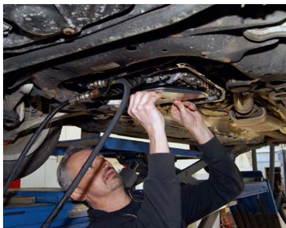
Nach dem Wechsel des Ölfilters kann die gereinigte Ölwanne wieder montiert werden.
