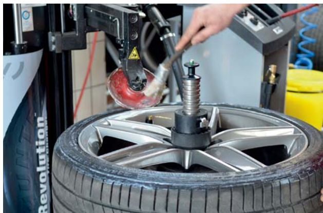
Sorgfältiges Fetten ist das A und O bei der Reifenmontage.
