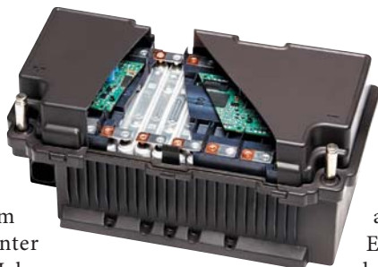
Eine 48-Volt-Lithium-Ionen-Batterie von Johnson Controls.
