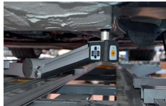
Schritt für Schritt werden alle Messpunkte unter dem Fahrzeug abgefahren.
