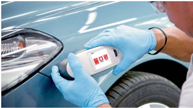
Axalta digitale Farbtonmessgeräte messen den Farbton der Originallackierung in der Nähe des Schadens aus drei Winkeln.
