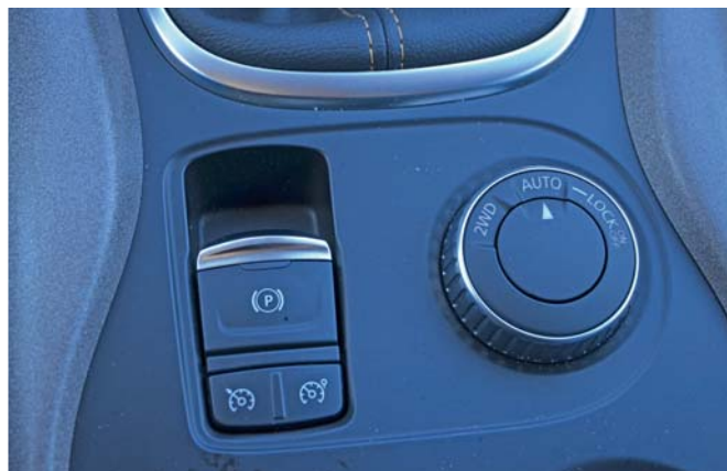
Blick auf die Mittelkonsole: Neben der elektrischen Parkbremse (links) lässt sich dort auch der Allrad-Antrieb aus- und einschalten (rechts).
