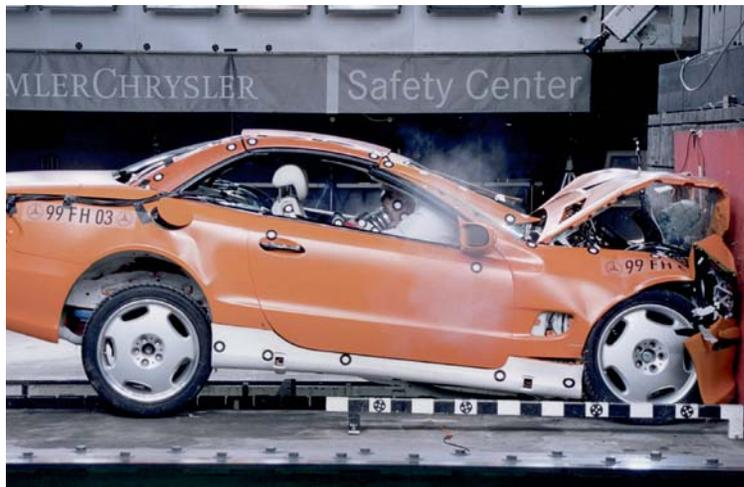
**Redundant: Mindestens zwei Airbag-Sensoren müssen den Zündimpuls geben, damit der Airbag ausgelöst wird.**
