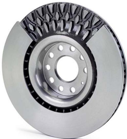
**PVT Plus-Bremsen stellen den jüngsten Zugang in der Reihe noppenbelüfteter Bremssysteme dar.**
