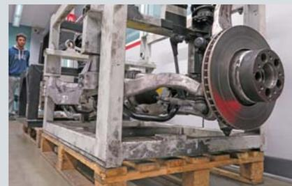
Auf unterschiedlich konfigurierten Prüfständen werden Bremssysteme auch in Verbindung mit Fahrzeugkomponenten getestet. Sensoren liefern Daten über den Zustand der Bremscheiben.
