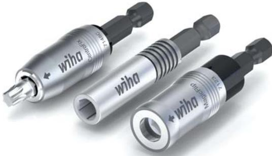
Die Bithalter der Centrofix-Baureihe von Wiha bieten eine hilfreiche Besonderheit: Beim Einstecken in den Bithalter wird der Bit automatisch verriegelt und sitzt laut Anbieter spielfrei. Beim „Magicflip Force“ genannten Bithalter ist ein verschiebbarer Ringmagnet integriert, der den Verlust von Schrauben verhindert. Dessen Zurückspringen in der letzten Verschraubungsphase gibt die Sicht auf
