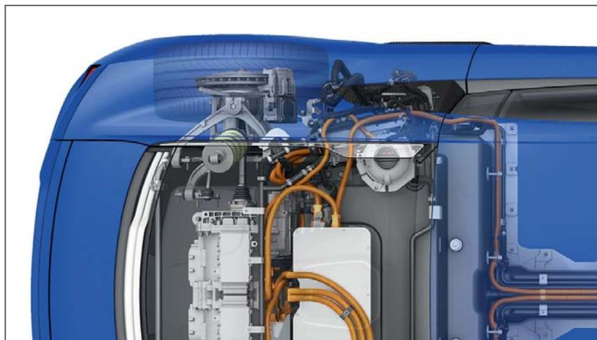
Die Röntgenzeichnung zeigt Position und Größe der hinteren Radbremsen. Je ein bürstenloser Elektromotor wirkt auf ein dreistufiges Stirnradgetriebe mit Rückdreheinheit und finalem Kugelgewindetrieb. Nennspannung: zwölf Volt
