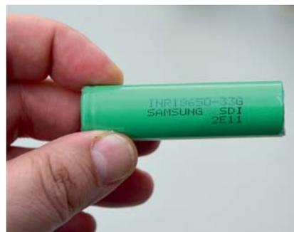
7.488 dieser Lithium-Ionen-Zellen, etwas größer als die Baugröße AA/R6, stecken im Akku des R8 e-tron.
