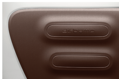
Airbumps an den Flanken und Ecken: Hohlräume erlauben den Oberteilen das Zurückspringen nach dem Eindrücken.
