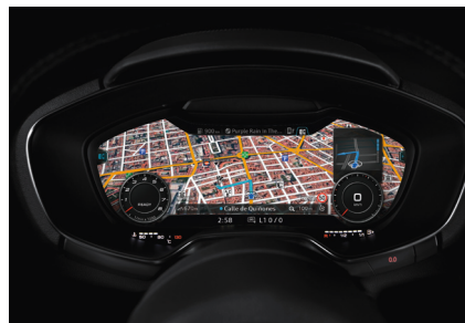
Eine von mehreren Cockpit-Ansichten: große Navigationskarte mit kleinen nachgebildeten Rundinstrumenten
