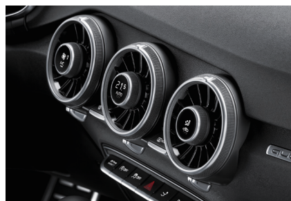
Die Anzeige von Temperatur und Modus der Klimaanlage ist in die mittleren Luftaustrittsöffnungen integriert.
