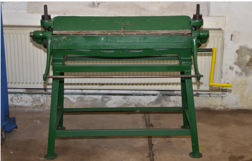
Auch eine alte, aber noch immer funktionierende Abkantbank findet sich in der Werkstatt von Marcus Metzner.
