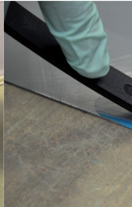
Fehlerhaft verklebte Bauteile können bis zu zwei Stunden nach Applikation des Klebers – ggf. mit gewissem Kraftaufwand – wieder getrennt werden.
