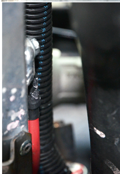
Masseverbindung zwischen hinterem (oben) und vorderem Hilfsrahmen (links). Die unglücklich gewählte rote Kabelfarbe ist auf das Vorserienfahrzeug zurückzuführen.
