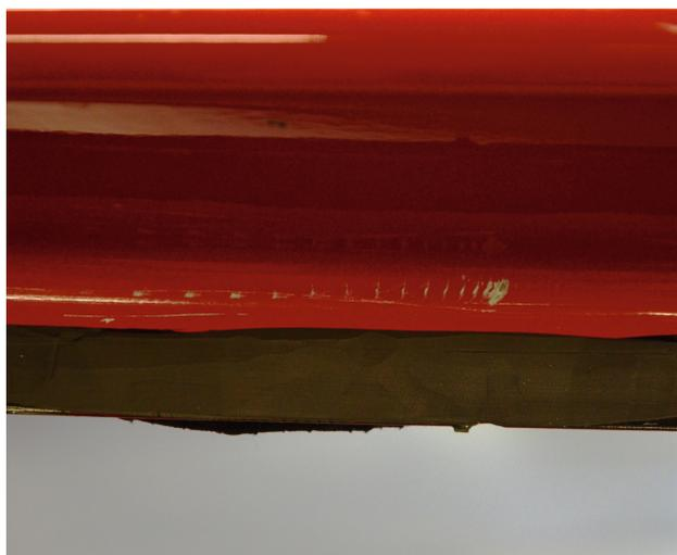
Für kleinere Schäden am Flansch genügt Primer als Korrosionsschutzmaßnahme.
