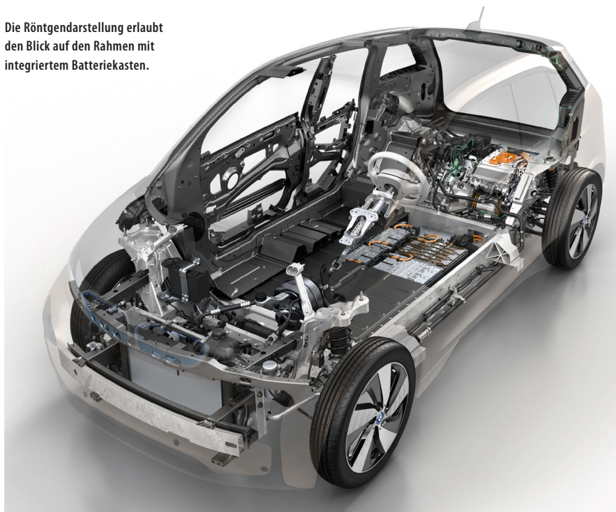
Jede Komponente der Fahrgastzelle des i3 besteht aus mehreren Lagen CFK-Material, auch Patches genannt,...
