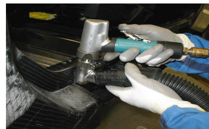
Trennung verklebter CFK-Schalen durch Fräsen mit einer speziellen Handfräsmaschine mit integrierter Absaugung
