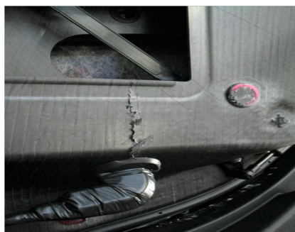
Bricht ein CFK-Bauteil, ist stets eine Bruchkante sichtbar. Das Bauteil muss in jedem Fall erneuert werden.
