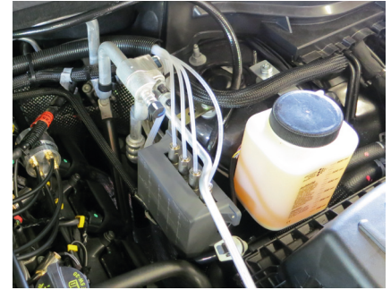
Zusätzliche Sicherheit gegen Ventilschäden: Während des Gasbetriebs wird ein Additiv injiziert.
