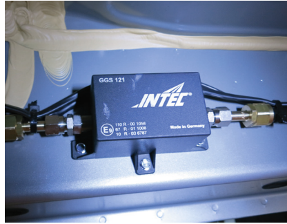
Der Gasmisch-Erkennungssensor GGS 121 kommuniziert direkt mit dem Gassteuergerät.
