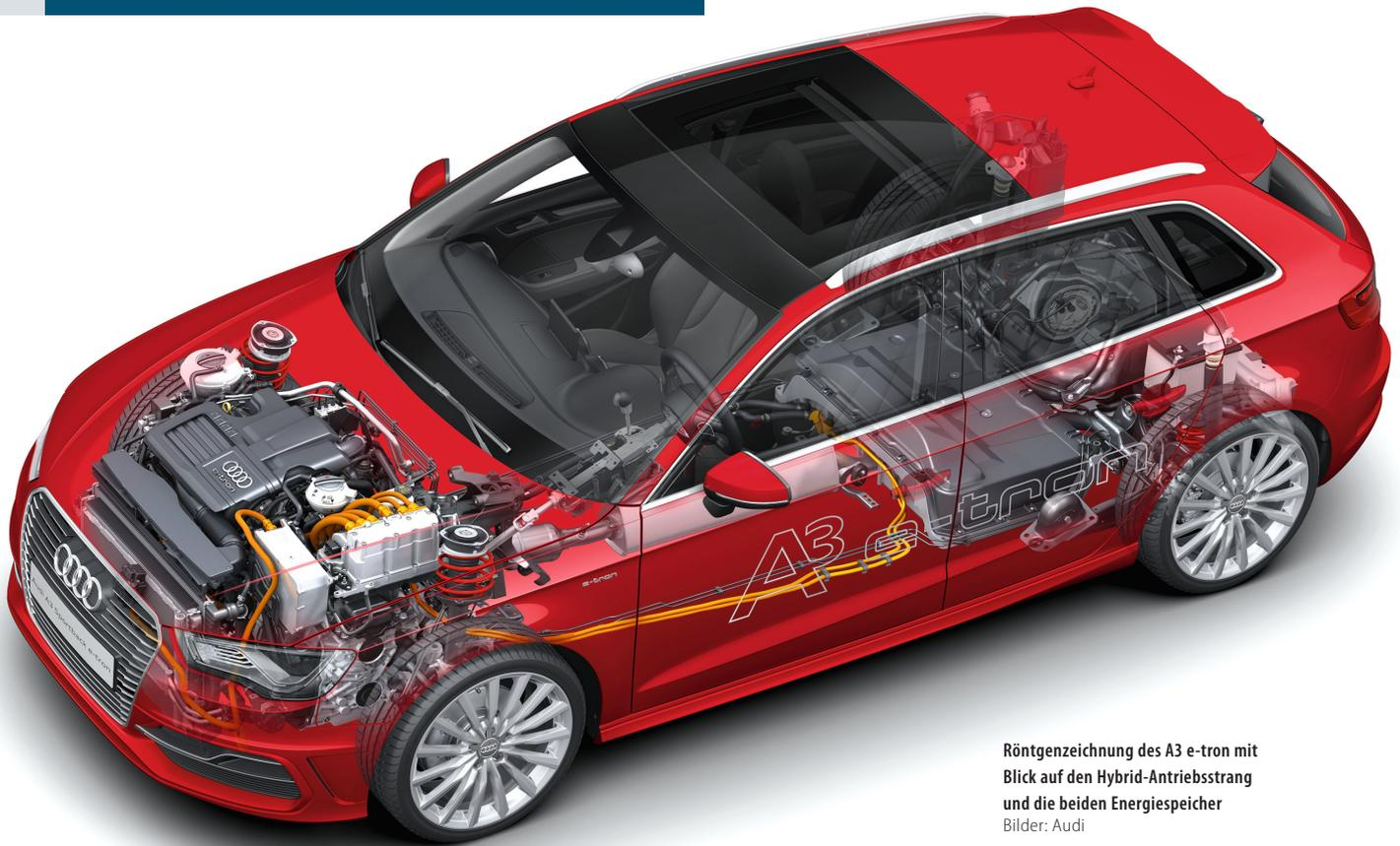
Röntgenzeichnung des A3 e-tron mit Blick auf den Hybrid-Antriebsstrang und die beiden Energiespeicher
