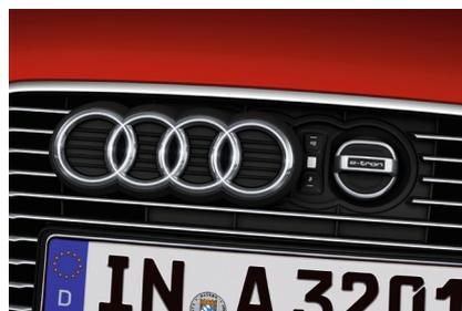
Das Markenlogo am Kühlergrill wird für die Aufnahme des Ladesteckers zur Seite geklappt.
