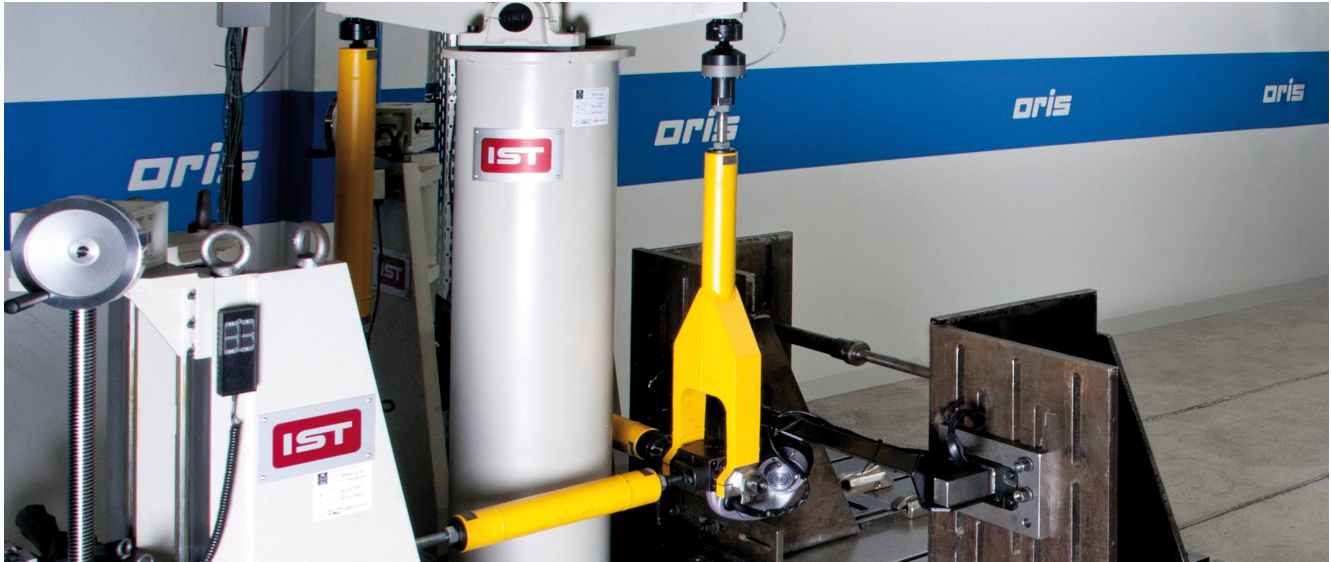
Prüfanordnung für den CARLOS TC BC-Test einer Anhängerkupplung bei Bosal Automotive Carrier and Protection Systems
