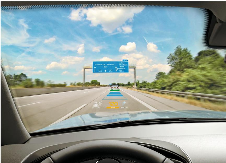
Augmented-Reality-Head-up-Display (AR-HUD) mit eingespiegelmtem Hinweis des ACC-Systems
