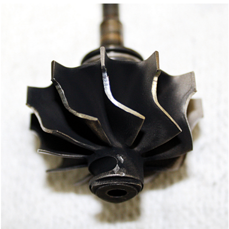
... das Turbinenrad ist mit dem Turbinengehäuse kollidiert (Schleifspuren an den Flügeln)...
