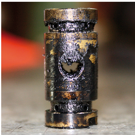
Vier eindeutige Zeichen für ein Ölproblem am Turbolader: das Radiallager ist verschlammte,...
