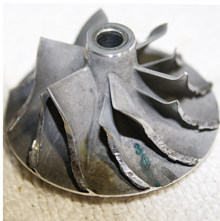
... und das Verdichterrad ist mit dem Verdichtergehäuse kollidiert (ebenfalls Schleifspuren an den Flügeln).
