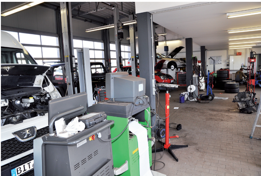
Der Blick in die Werkstatt zeigt Vollausslastung. Deckenhöhe und Tragkraft der Bühnen wurden so gewählt, dass auch Transporter problemlos repariert werden können
