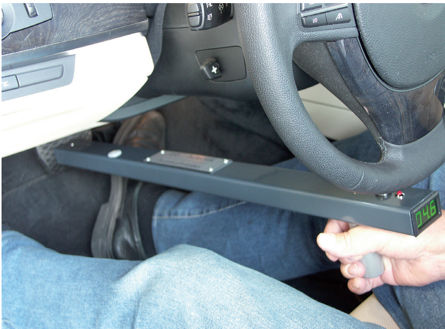
Mit dem handbetätigten Pedalkraftmesser wird die Betätigungskraft des Bremspedals erfasst und via Funk übertragen
