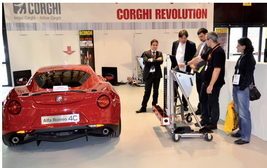
Bei diesem berührungslos arbeitenden Fahrwerksvermessungssystem aus der R.E.M.O.-Serie von Corghi schiebt der Anwender die Messtechnik auf einem Wagen von Rad zu Rad. Vorteil ist die Beschränkung auf nur einen Messwertnehmer.
