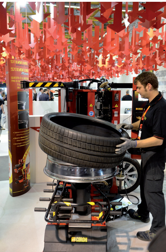
Die High-End-Reifenmontiermaschine Corghi Artiglio Master Code de- und montiert jetzt vollautomatisch.
