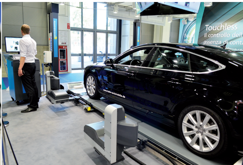
Premiere bei Beissbarth: Die Münchner präsentierten auf der Autopromotec das berührungslos messende Fahrwerksvermessungssystem Touchless II erstmals als komplettes System mit Bühne und vier Messwertaufnehmern.
