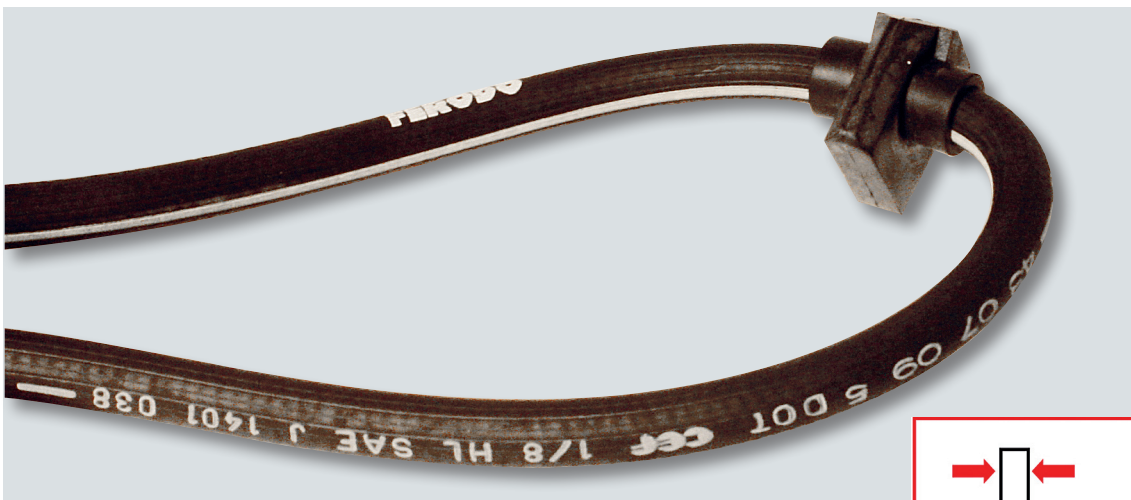
Geknickte Bremschläuche sollte man, selbst wenn sie neu sind, nicht mehr verbauen, sondern ersetzen.
