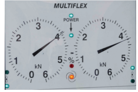
AHS-Allradmodus: Die untere linke Richtungslampe blinkt, das linke Rad wird gegen die Fahrtrichtung angetrieben.
