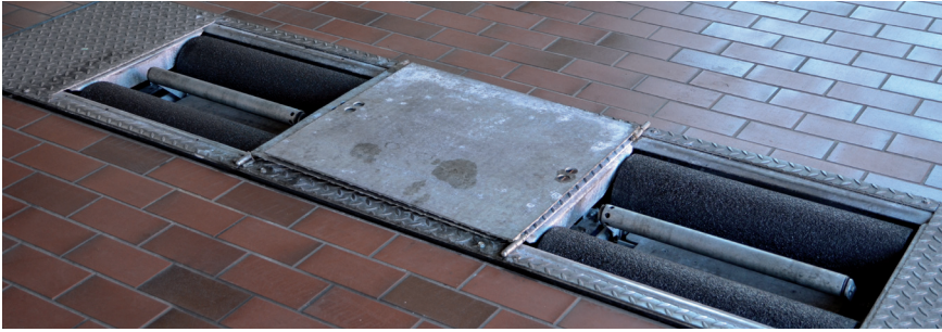
Der Rollensatz des Multiflex 05 Edition 2013 entspricht in allen Details der neuen Bremsprüfstandsrichtlinie.
