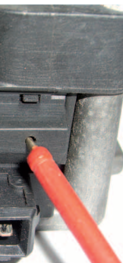
Zündspulen mit Endstufe: weitere Anschlüsse unter einer Abdeckung (Klemmen 15 u. 1)
