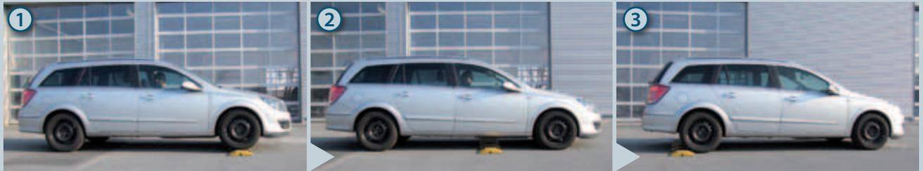
Bei der von der FSD entwickelten Prüfmethode fährt ein Auto nacheinander mit beiden Achsen über eine Schwelle und der HU-Adapter 21 wertet die Schwingungen aus
